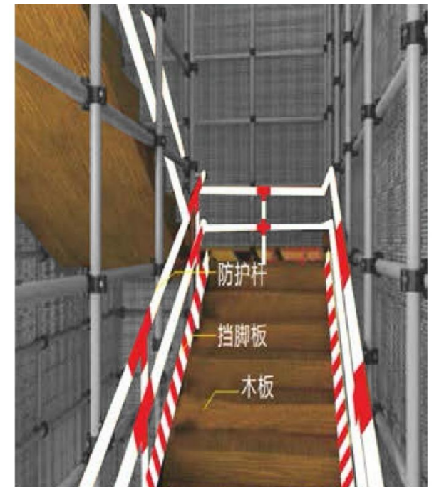
钢管式脚手架通道
