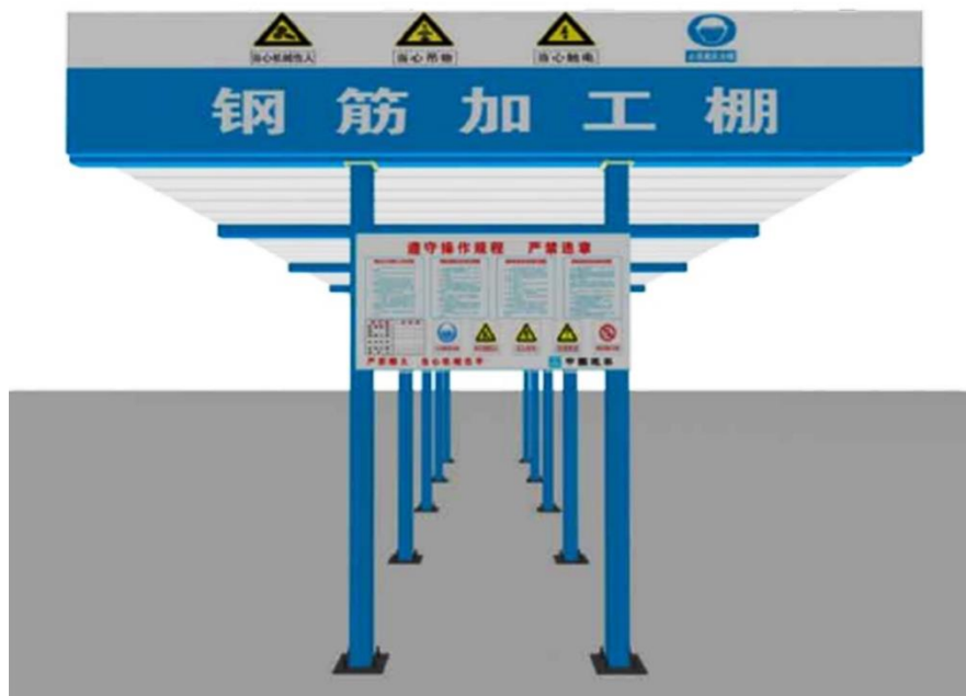
双立柱钢筋加工棚
