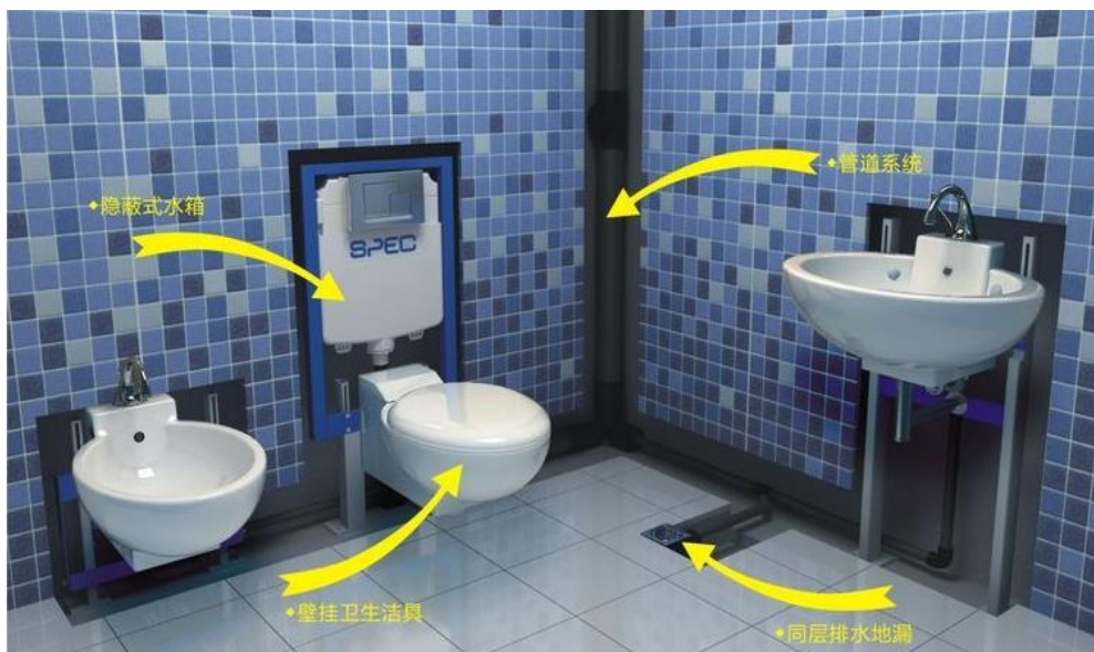
图 2.3 同层排水效果示意图
