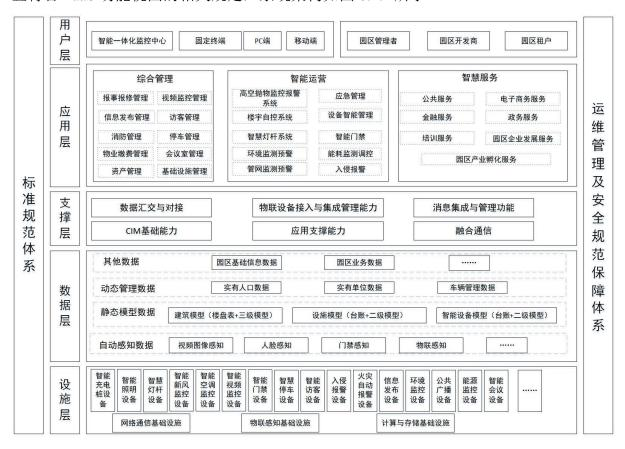
图 6.1.1 智慧园区综合信息服务系统架构图
